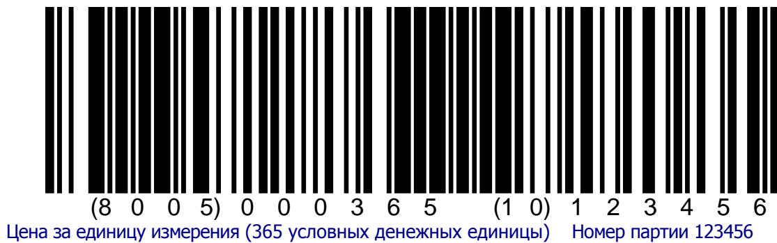
Рисунок 10 - Объединенный символ, представляющий цену за единицу измерения (365 условных денежных единицы) и номер партии 123456
